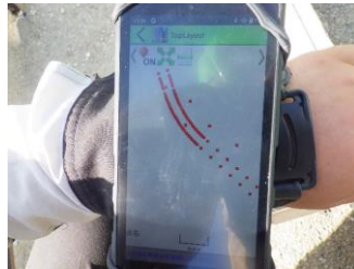
▶杭ナビ操作画面（ボックス設置位置）
