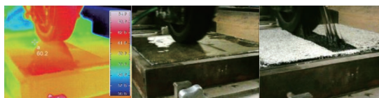
(左から、温度測定状況、接着防水材、塗膜防水材) 写真-1 防水層上のホイールトラッキング走行試験
