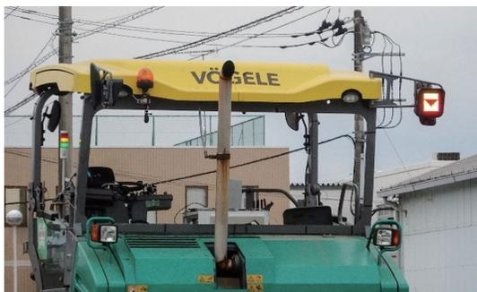
写真-9 ダンプ誘導装置のインジケータ表示
