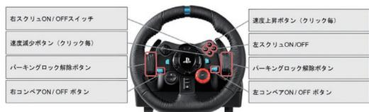
図-3 遠隔操作ボタンの配置
