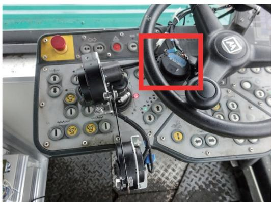
写真-5 走行速度ダイヤル制御装置(赤枠部)
