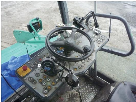
写真-3 AF操作盤の制御機器設置状況(全景)
