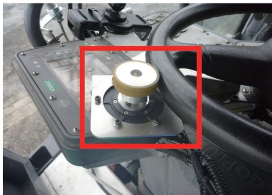
写真-6 ステアリング制御装置(赤枠部)
