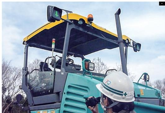
写真-12 ダンプ誘導装置の音声操作検証状況
