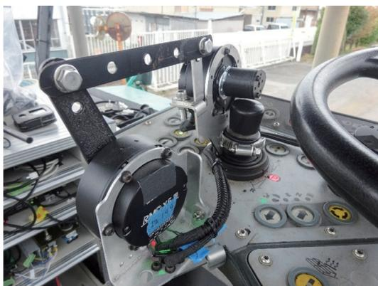
写真-4 前後進レバー制御装置
