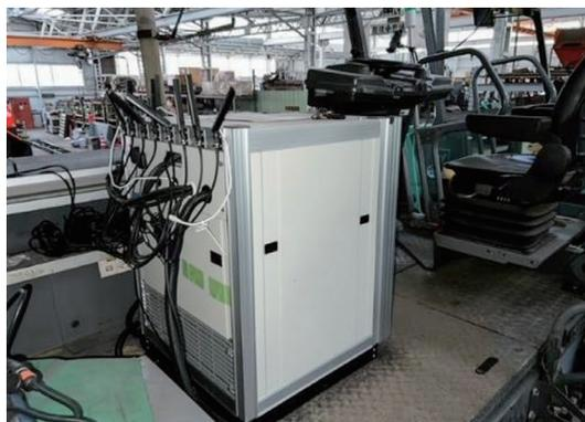
写真-7 AFに搭載した通信・制御PCユニット
