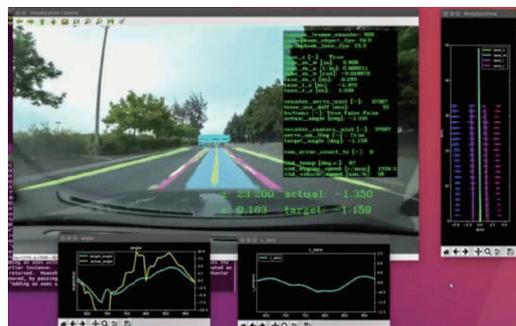
図-6 AIによる自動操舵解析イメージ
