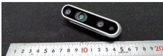
写真-3 選定した3次元カメラの外観
