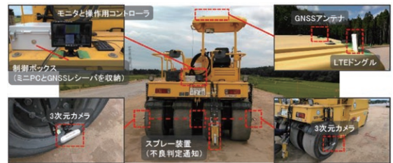
写真-7 機材取り付け状況
