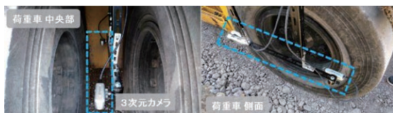
写真-4 3次元カメラの取り付け状況
