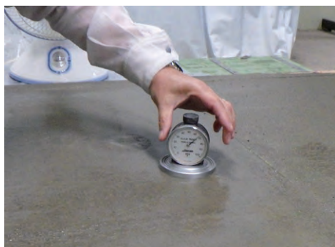
写真-3 表面モルタル硬さ測定状況
