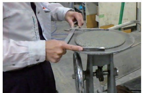
写真-2 テーブルフロー試験状況
