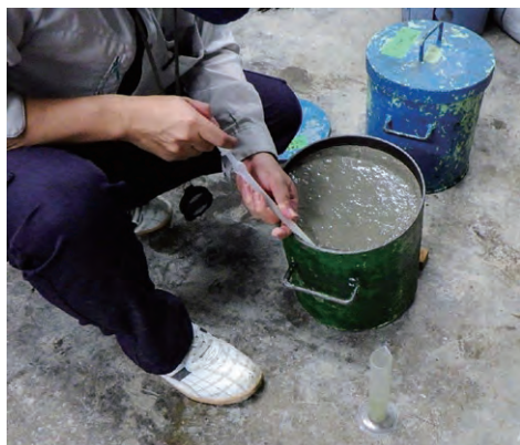
写真-1 ブリーディング測定状況
