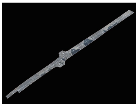
図-2 色彩補填された起工測量計測データ
