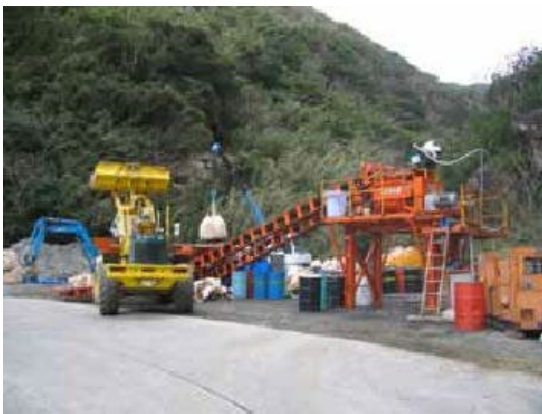
鹿児島県三島村黒島における常温再生混合物の製造と施工
