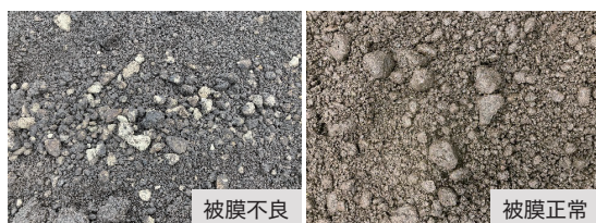
写真－1 CAE路盤材料の被膜状態の判断基準
